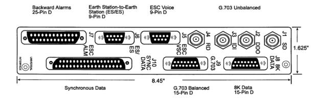
Figure 5-8 Front Panel Interface - DDS20 Data Switch Module
